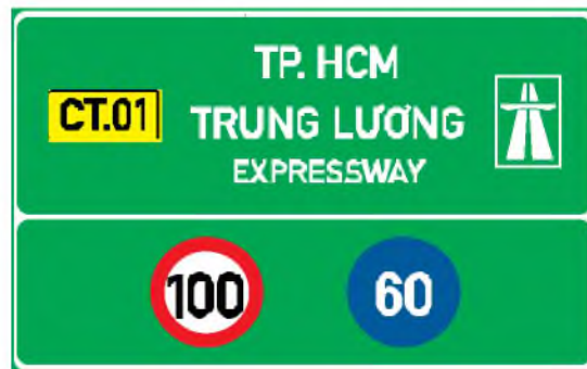
Hình 9a - Biển số IE.452 chỉ dẫn bắt đầu đường cao tốc
