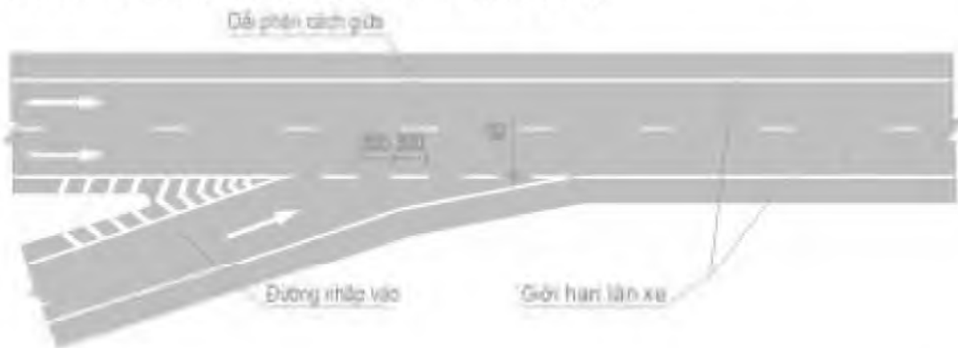
Hình G.16 - Minh họa bố trí vạch sơn khu vực nhập làn kiểu trực tiếp
