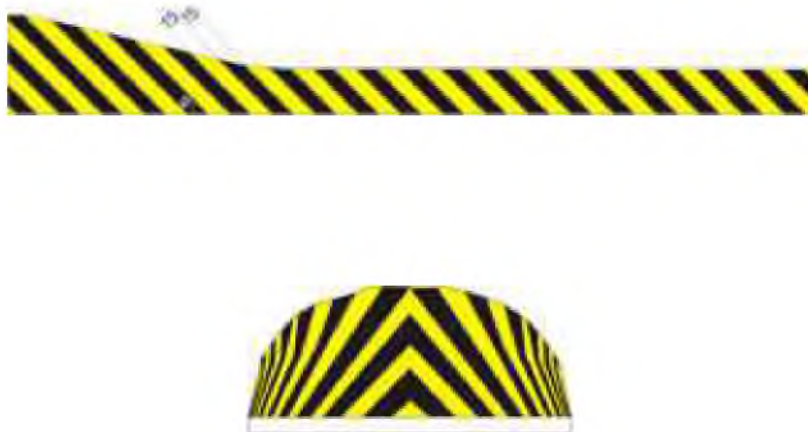
Hình G.64 - Sử dụng vạch 8.1 trên đảo phân làn tại trạm thu phí - Mẫu 2
