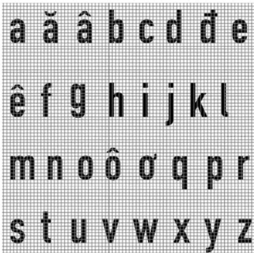
Hình K.5 - Chi tiết chữ viết dạng chữ thường, kiểu chữ nén (gt1)
