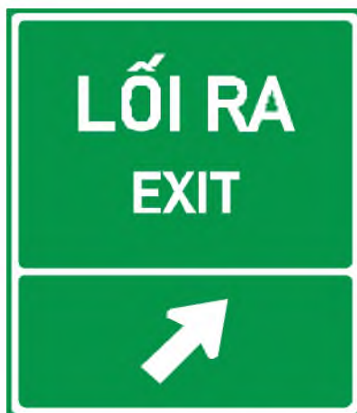
Hình 33 - Biển số IE.474 chỉ dẫn lối ra
