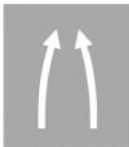
Hình G.75 - Vạch mũi tên báo số làn xe phía trước bị giảm
