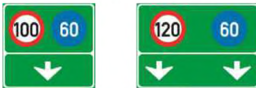
Hình 9b - Biển chỉ dẫn bắt đầu đường cao tốc phân làn đường có tốc độ khác nhau
