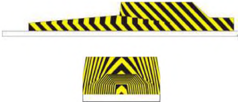
Hình G.63 - Sử dụng vạch 8.1 trên đảo phân làn tại trạm thu phí - Mẫu 1
